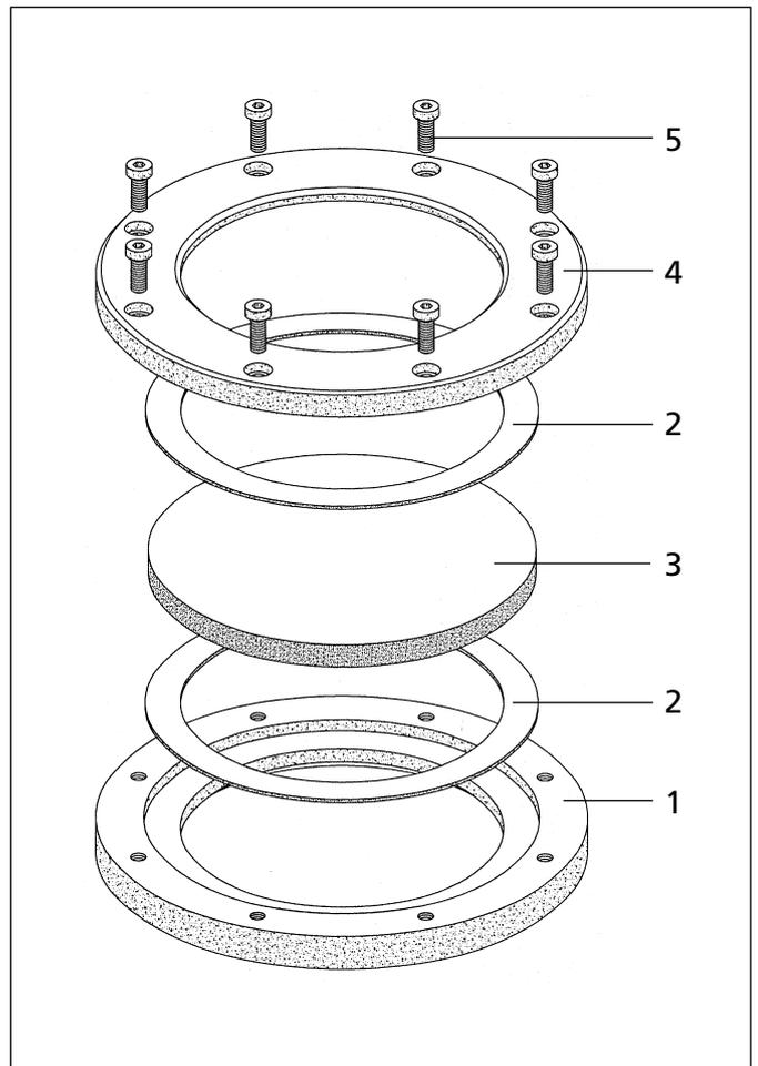
Aufbau einer Lumiglas Schauglas-Armatur aus Edelstahl
